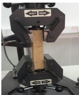
شکل ۴. نمونه‌های خشی در داخل دستگاه آزمون کشش
