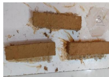
شکل ۱. نمونه‌های خشتی بعد از قالب‌گیری با قالب‌های چوبی با ابعاد 3 \times 10 \times 3 سانتی‌متری
