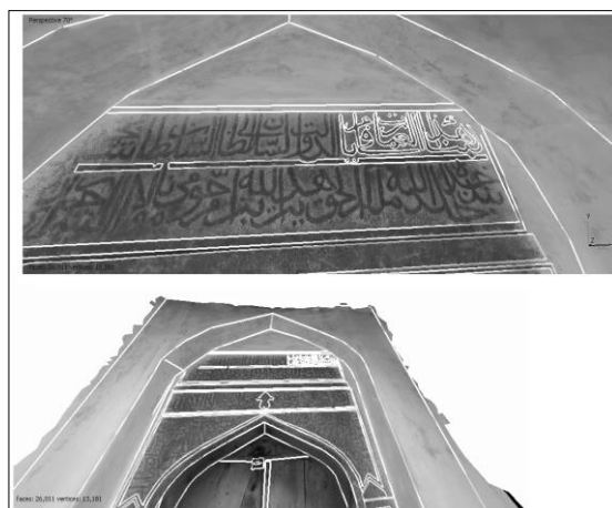
ت ۹. ترسیم نقشه‌های خطی کتیبه موجود در سردر خانه سرخای روی مدل سه‌بعدی
