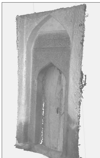
ت۵. ابرنقطه متراکم سردر خانه سرخای حاصل از فتوگرامتری بردکوتاه
