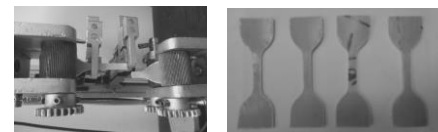
ت۱۸. نمونه‌های برش خورده از لوله PVC قبل و بعد از انجام آزمایش - مرکز پژوهش متالورژی رازی.
