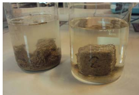
ت ۴. آزمایش غوطه‌وری (نمونه شماره ۱ و ۲).
