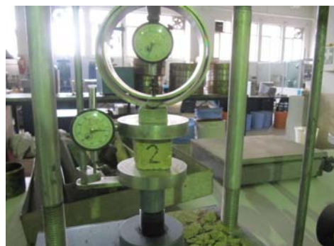
ت ۱. آزمایش مقاومت فشاری به وسیله دستگاه تک محور.
