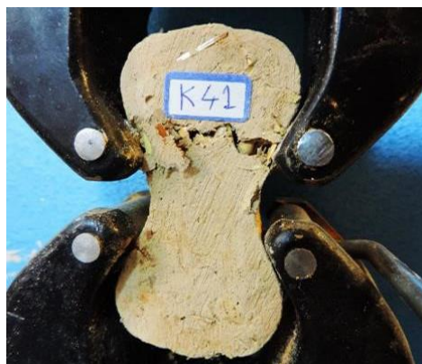
ت ۱۵. گسیختگی نمونه کاهگل پایونی در دستگاه بریکت. مأخذ: نگارنده.
