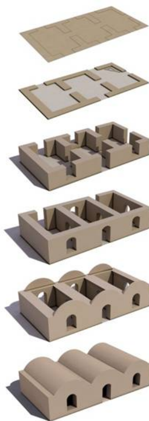
ت 10. مراحل اجرای خانه با تاق ضربی.
