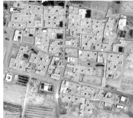
ت ۶. خانه های چهارصفه در عکس هوایی روستای مزرعه کلاتر در نزدیکی یزد مأخذ: گوگل.
