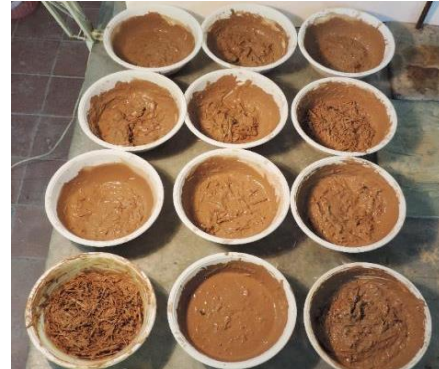
ت ۸. نمونه‌های کاهگل تهیه شده با درصد‌های مختلف کاه. مأخذ: نگارنده.
