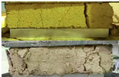
ت ۱۲. ترک‌های ایجاد شده در نمونه (C+S+G) در آزمایش فشاری.
