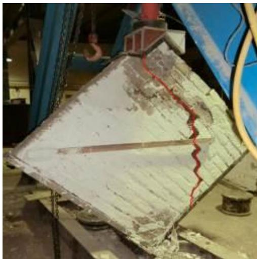
ت ۱۸. ترک‌های ایجاد شده در دیوار خشتی با ملات ساده پس از آزمایش کشش قدری.
