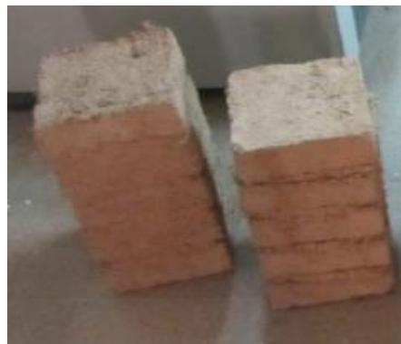
ت ۱۵. نمونه‌های ۵ تایی برای آزمایش فشاری.
