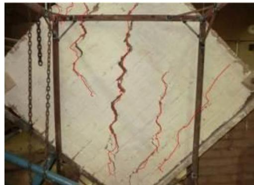
ت ۱۹. ترک‌های ایجاد شده در دیوار خشتی با ملات کاه‌گل پس از آزمایش کشش قطري.
