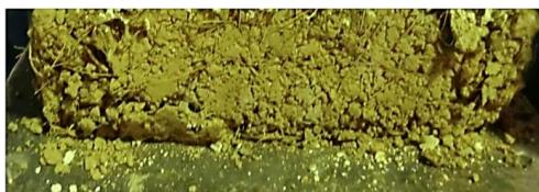
ت ۱۳. ترک‌های ایجاد شده در نمونه (C+S+G+0/9P) در آزمایش فشاری.
