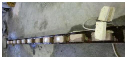
ت ۱۰. شمای آزمایش مقاومت برشی مصالح بنایی.
