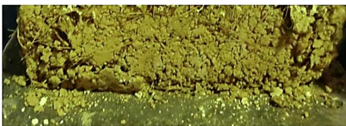
ت ۱۳. ترک‌های ایجاد شده در نمونه (C+S+G+0/9P) در آزمایش فشاری.
