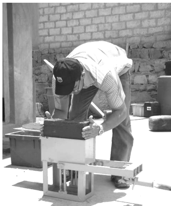
تصویر ۱- تولید بلوک‌های متراکم و تثبیت شده در مناطق کم درآمد
