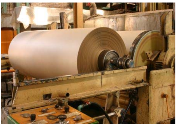
"ت ۱" دستگاه‌های تبدیل خمیر چوب به رول های کاغذ.
