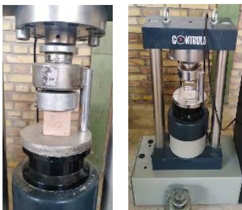
شکل ۵. راست: دستگاه جک ملات‌شکن اتوماتیک ایتالیایی با ظرفیت ۳۰ کیلونیوتن (Controls- Model 65)
