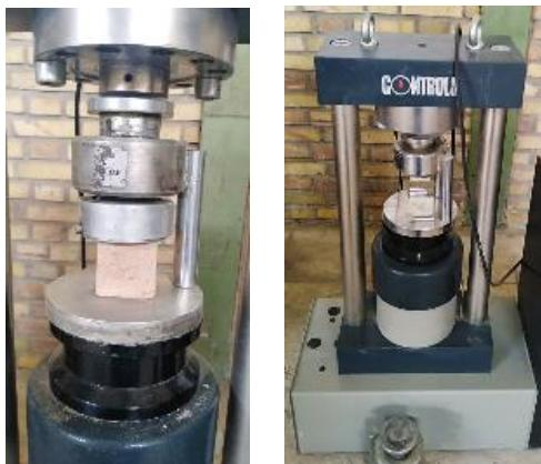
شکل ۵. راست: دستگاه جک ملات‌شکن اتوماتیک ایتالیایی با ظرفیت ۳۰ کیلونیوتون (Controls- Model 65)
