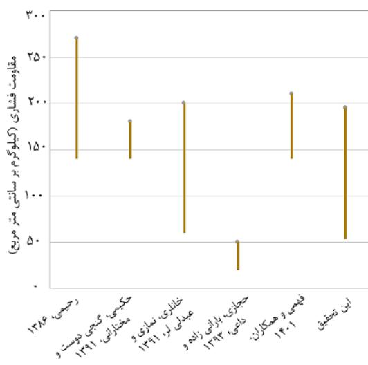
شکل ۶. مقایسه مقاومت فشاری آجرها در منابع مختلف با مقاومت فشاری‌های به دست‌آمده در این پژوهش
