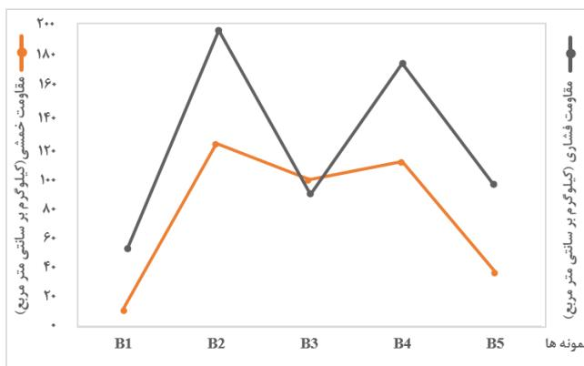
شکل ۸. مقایسه دو نمودار مقاومت فشاری و مقاومت خمشی نمونه‌های آجری به ترتیب دوره زمانی
