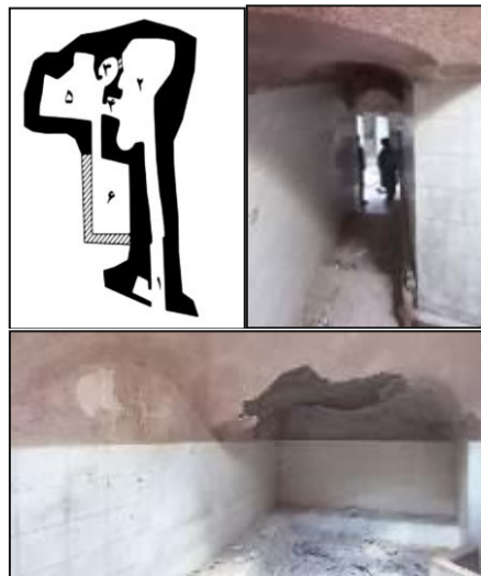
۱. ورودی ۲. سرپینه ۳. میاندر ۴. اتاق نظافت (فضاها) الحاقی) ۵. پینه ۶. الحاقات دوره جدید بخش اصلی الحاقات
