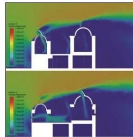
ت ۲۹. مقطع ساختمان و نحوه ورود هوای به اتاق‌ها (در حالت کُلک با دهانه بازتر)
