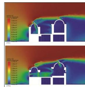
ت ۲۰. مقطع ساختمان و نحوه ورود هوا به اتاق‌ها - حالت باد عمود بر دهانه گلک
