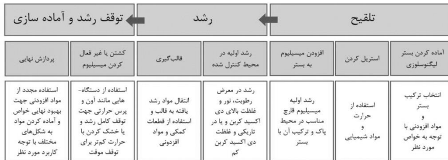
شکل ۴. مراحل اصلی تولید بیوکامپوزیت‌های میسلیمی
