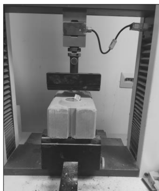
ت ۶. دستگاه آزمون خمش سه نقطه‌ای
