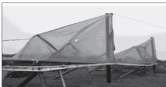
ت ۱۲. نمونه دستگاه جمع‌آوری آب از مه، که در برابر فشار باد مقاوم‌سازی شده است (Holmes et al., 2015, 243)
