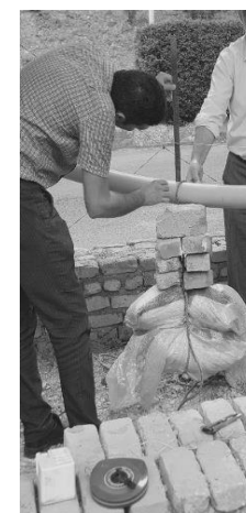
ت ۱۰. بارگذاری ۵۶ کیلویی لوله ۹۰ فشار نیمه‌قوی.
