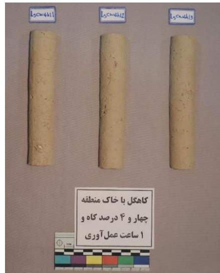
ت ۱۰. نمونه‌های کاهگل نیم استوانه‌ای برای تعیین انقباض خطی. مأخذ: نگارنده.
