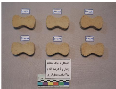
ت ۱۱. نمونه‌های کاهگل پاپیونی برای تعیین مقاومت کششی. مأخذ: نگارنده.
