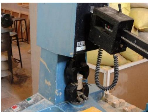
ت ۱۳. تعیین مقاومت کششی نمونه‌ها با بریکت.
