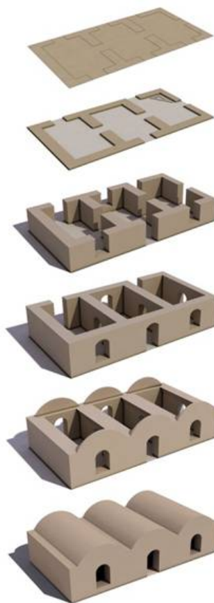
ت 10. مراحل اجرای خانه با تاق ضربی.
