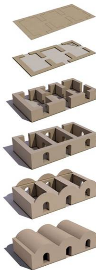
ت 10. مراحل اجرای خانه با تاق ضربی.
