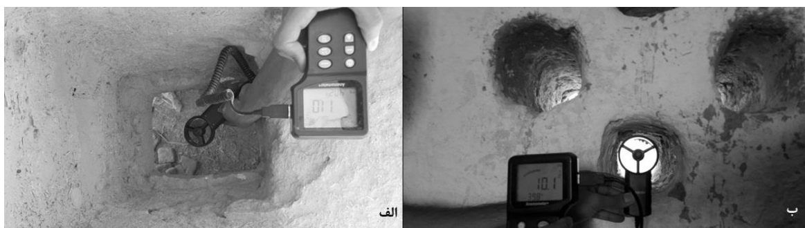
ت ۵. تصاویری از اندازه‌گیری سرعت باد در اتاق‌های بومی (الف- سرعت باد در دهانه ورود باد از کلک، ب- سرعت باد در دهانه ورودی باد از دریچه‌های مشبک). مأخذ: نگارندگان.
