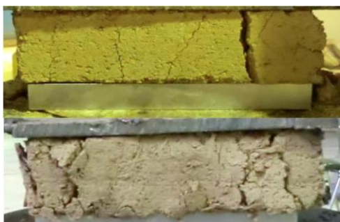
ت ۱۲. ترک‌های ایجاد شده در نمونه (C+S+G) در آزمایش فشاری.
