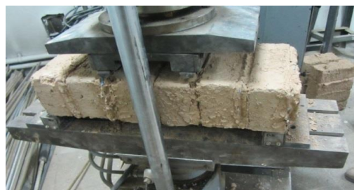
ت ۱۶. آزمایش خمشی بر روی نمونه های منشوری ساخته با ۶ ردیف خشت
