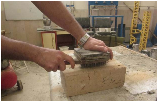
ت ۹. نحوه انجام آزمایش مقاومت سایشی.
