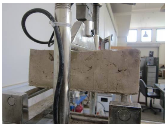
ت ۷. آزمایش مقاومت خمشی خشت.
