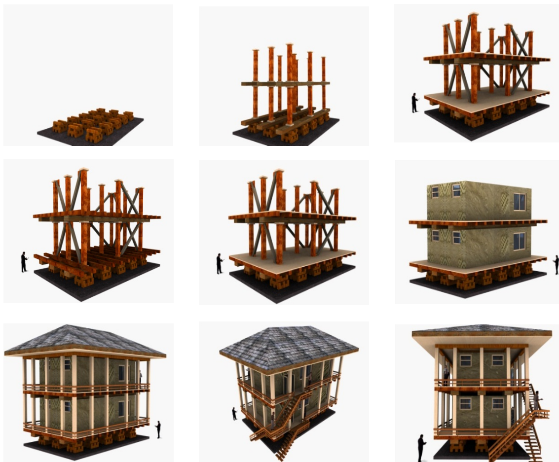
ت ۲. نحوه برپایی سازه مدل شده از ابتدا تا انتها.
