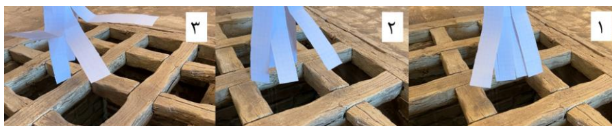
شکل ۵. مشاهده‌ی جریان هوا از زیرزمین به میان‌خانه به صورت ملموس
