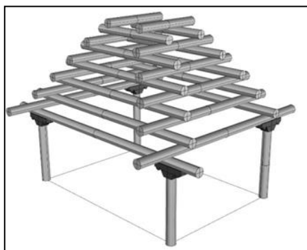
ت ۲. نحوه قرارگیری چوب‌ها به شکل هرمی جهت ساخت بونه‌غی.
