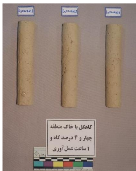
ت ۱۰. نمونه‌های کاهگل نیم استوانه‌ای برای تعیین انقباض خطی. مأخذ: نگارنده.
